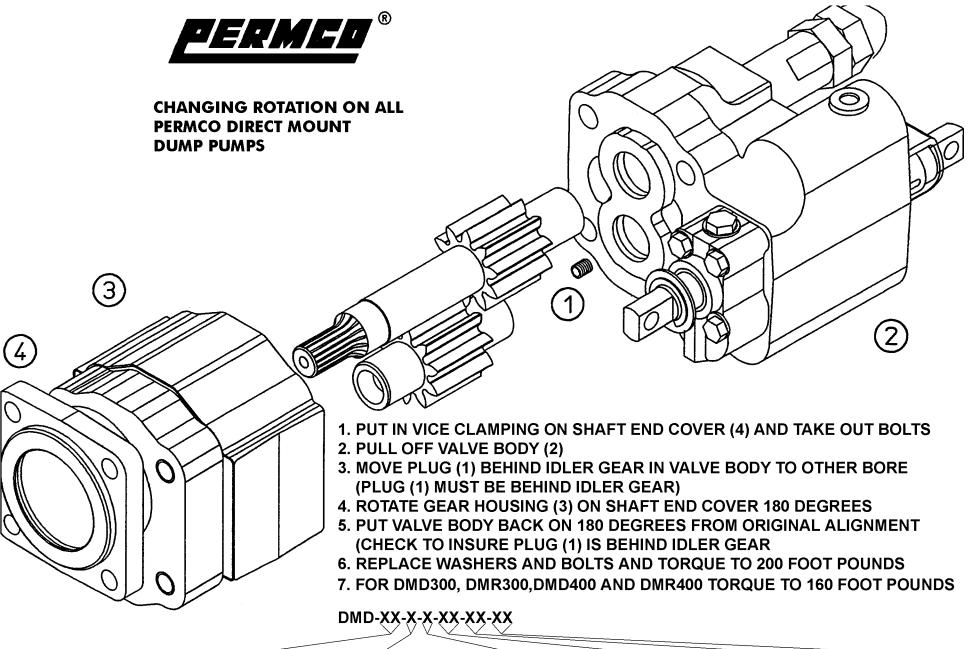
GEAR SIZE X-2 LINE R-RIGHT HAND AS-AIR SHIFT
